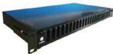
I cassette ottici Netleo ad 1U sono adatti per una veloce e facile gestione delle fibre all'interno di rack 19". È fornito di vassoio estraibile con chiusura easy clip pannelli a scatto per facilitare l'accesso alle terminazioni. Può alloggiare fino a 96 fibre tramite adapter SC-LC-ST Duplex.
